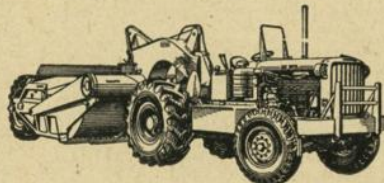
SCHÜRFKÜBELWAGEN 2- und 3-achsig von 180 bis 300 PS und 9,5 bis 21 m 3 Wageninhalt
