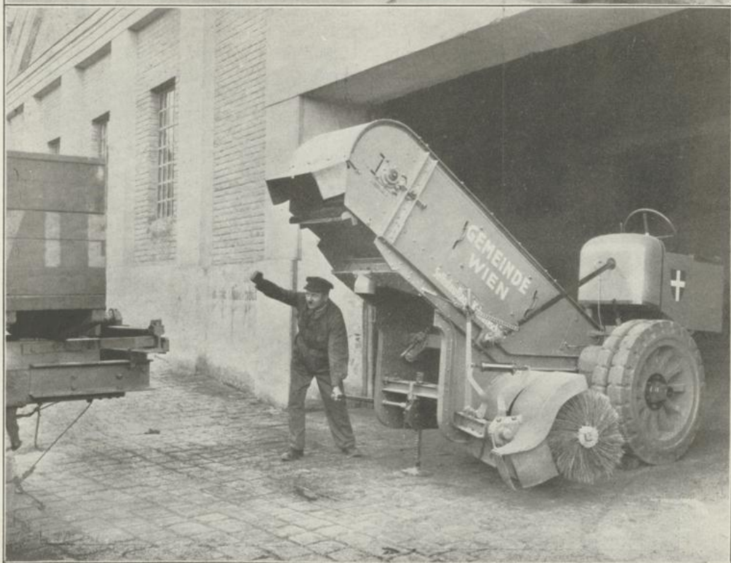
Kehrmaschine mit automatischer Vorrichtung für die Kehrrichtaufnahme
