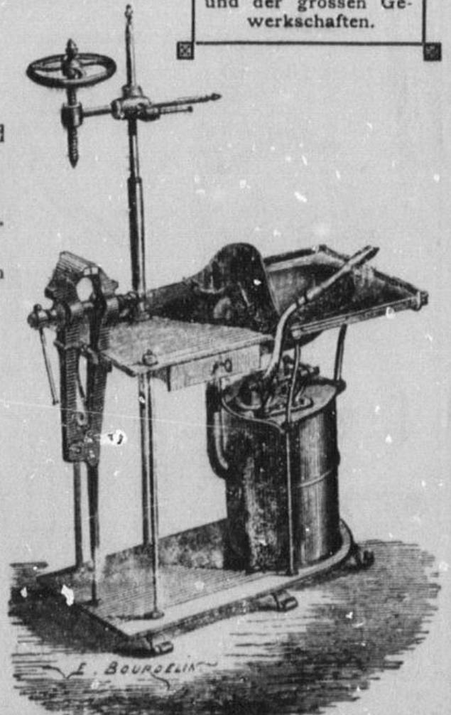
Tragbare Schmiede, mit doppeltem Gebläse u. drehbarem Hebel
