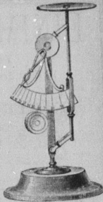
Hebelwaage mit Teller (100 grammes).
