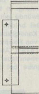
Doppelrammhaube aus Flußstahl oder Stahlguß für den Einsatz von Stampfern oder Fallhämmern
