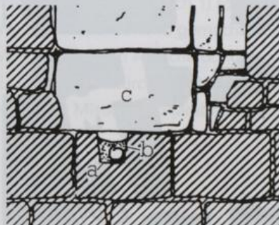
Kupferrohrkanalisation im Sahu-Rê-Tempel: a) Führungsrinne, b) Gipsmörtelfüllung mit Kupferrohr, c) Abdeckplatte
