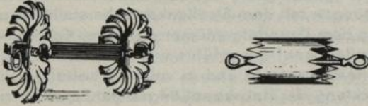
zum Losreissen von starken Verwachsungen in Kanälen.
