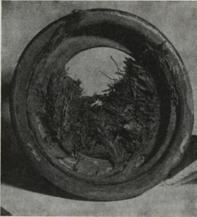
Verwurzelung eines Steinzeugrohres
