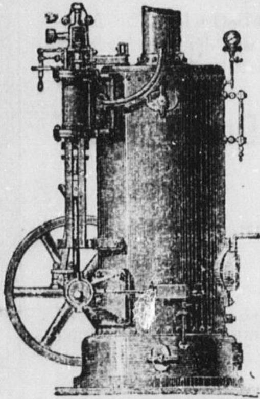
**Dampfmotoren** von 1–25 Pferdekr., mit Meyer'scher oder Ridersteuerung, geringster Kohlenverbrauch garantiert.
