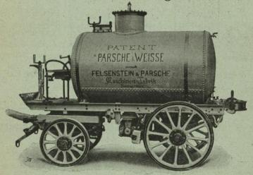
Patentierte automatische Aufspritzwagen mit Luftdruck.
