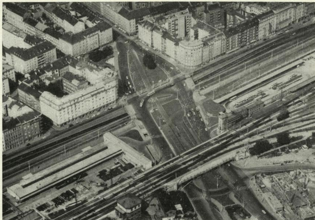
Verkehrslösung Südtiroler Platz. Hier wurde im Zuge der Gürtelschnellstraße bei der Favoritenstraße eine vierspurige Unterführung für den Individualverkehr und unterirdische Haltestellen für Straßen- und Schnellbahnen geschaffen.
