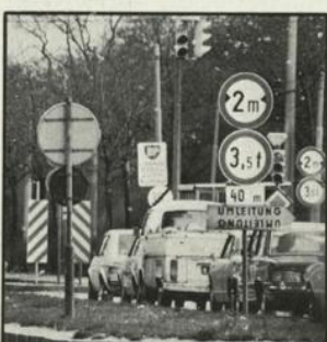
▲ Rückstrahlende, emailierte und innenbeleuchtete Schilder
