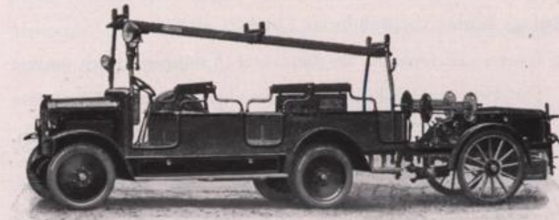
Automobile Benzinmotor-Feuerspritze, Sechszylinder-Motor, 45 PS, Wasserlieferung 1100—1700 Liter
