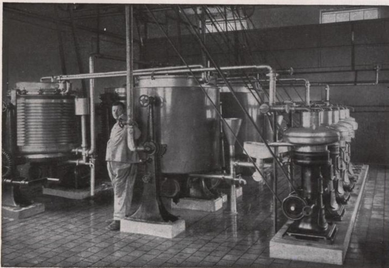
Milchreinigungs- u. Pasteuriseranlage der Niederösterreichischen Molkerei
