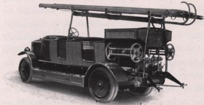
Automobile Benzinmotor-Feuerspritze, Sechszylinder-Motor, 45 PS, Wasserlieferung 1100—1700 Liter
