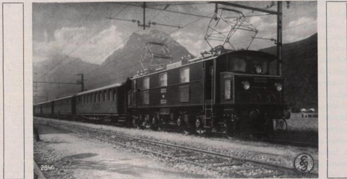
Elektrische Schnellzugslokomotive, Achsfolge 1-D<sub>0</sub>-1, der ÖSSW für die österreichischen Bundesbahnen (3000 PS Stundenleistung, Höchstgeschwindigkeit 100 km/Std.)
