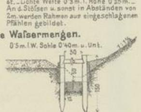
Wo Jund. Wälder vorhanden, sollen im Materialgr. Stücke stehen gelassen werden. Materialgräben in grossem Gefälle werden durch Schlickzäune, Pflaster oder Faschinaden an den Abstürzen gesichert.
