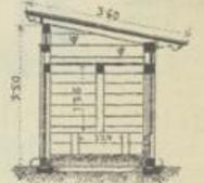
**Brückenwaage mit Waghäuschen ohne Geleise-Unterbrechung, 20 Ton. Tragkraft, in den Stationen Zólkiew und Betzec. 1:200.**
