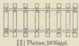
Länge der Bogenschienen 7'4 m. Die Verteilung der Schwellen Unterlagsplatten und Nägel bei den Bogenschienen ist die gleiche wie bei Normalschwellen.
