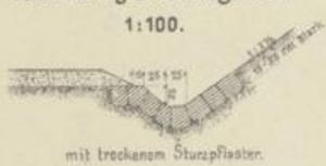
Versicherung d. Böschungsfußes.
