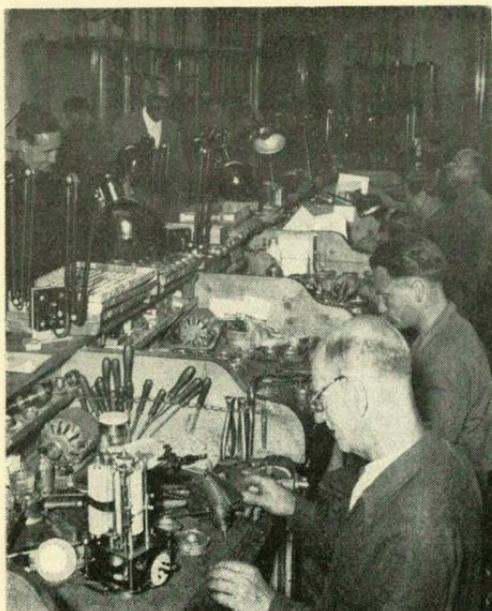
In der Reparaturwerkstätte der Wasserwerke werden die Meßuhren der Wassermesser von qualifizierten Arbeitern zerlegt und gereinigt.
