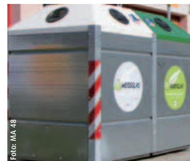
„Glashubbehälter“ verursachen bei ihrer Befüllung bedeutend geringere Lärmemissionen
