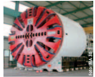
Die 136 m lange und 1.090 t schwere „Erddruckschildmaschine“ bei ihrer letzten Prüfung im Werk
