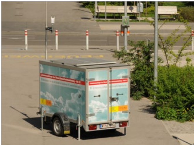
Solarbetriebener Lärmessanhänger der MA 22.
