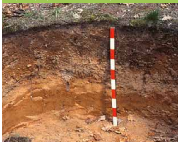
Bodenprofil eines im Westen und Norden in Wien vorkommenden Bodentyps: Braunerde
