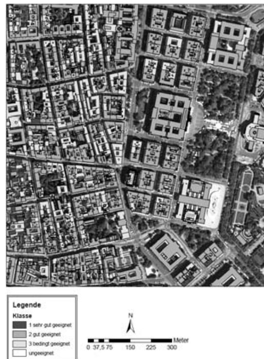
Abb. 3: Gebäudescharfe Auswertung für eine mögliche Photovoltaiknutzung der Dächer © Steinbeis-Transferzentrum für Geoinformation & Landmanagement
