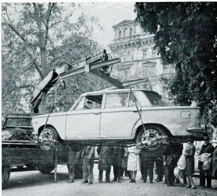
Ein neues Gerät ermöglicht das raschere Abschleppen von Autos
