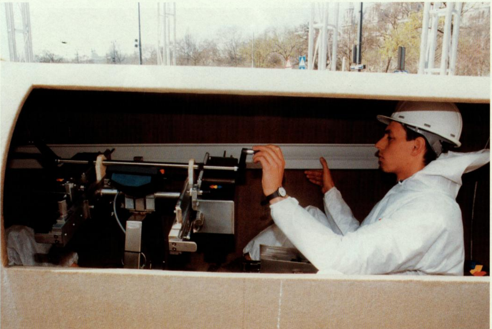
Unter der Bezeichnung „SewerLine“ entwickelte die MA 30 – Wien-Kanal eine neue Technologie zur effizienten Verlegung von Telekommunikationsleitungen im Wiener Kanalnetz.
