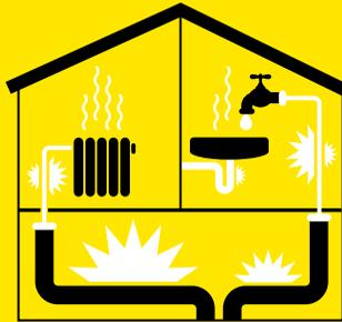
Jene Wärme, die beim Heizen verloren geht (z.B. Verluste in der Heizanlage, Verluste in der Warmwasserbereitung, Verluste in den Verteilsystemen etc.).
