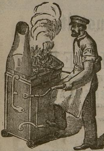
K. k. leichttransportable doppelwirkende Cylinder-Feldschmiede.
