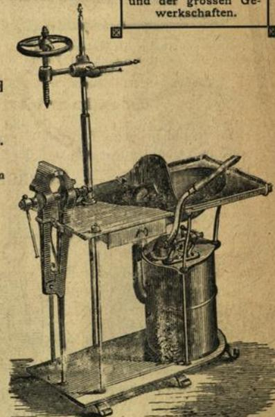
Tragbare Schmiede, mit doppeltem Gebläse u. drehbarem Hebel
