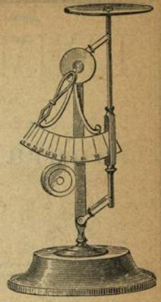
Hebelwaage mit Teller (100 grammes).
