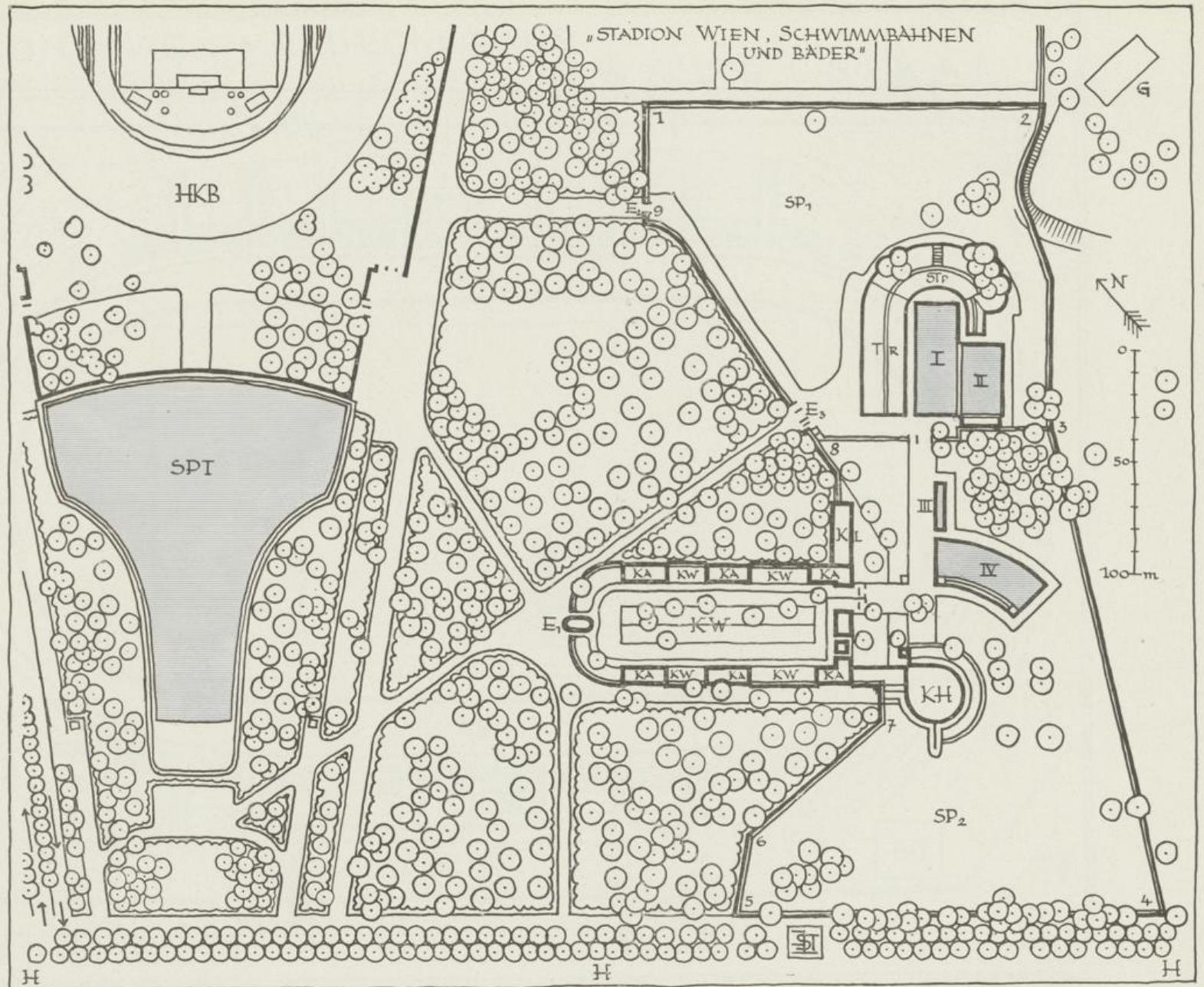
I SCHWIMMBAHN, 50 METER / II SPRUNGBECKEN, 33 1/4 METER / III KINDERBAD / IV PLANSCHBAD / TR TRIBUNE / STp STEHPÄTZE / KL KLÄRANLAGE / KA KABINEN / KW KABINEN, ERWEITERUNG / E 1 EINGANG, KASSA / E 2, E 3 EINGÄNGE BEI WETTBEWERBEN / KH KAFFEEHAUS / SP 1 UND 2 SPIELWIESEN / 1-9 EINFRIEDUNG / 3-8 TRENNUNG VON SPORT- UND ÖFFENTLICHEM BAD / HKB STADION, HAUPTKAMPFBahn / SPT SPIEGELTEICH / H PRATER HAUPTALLEE / G GOLFklub
