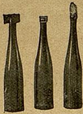
Abb. 15. Links, Korken durch Schieber, in der Mitte durch Bindfaden festgehalten, rechts Watteverschluß.
