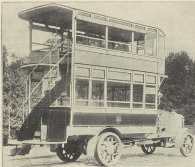
Fig. 3. Benzin-Kraftstellwagen mit ganz geschlossenem Obergeschoß, Patent Spängler. Chassis der engl. Daimlerwerke.
