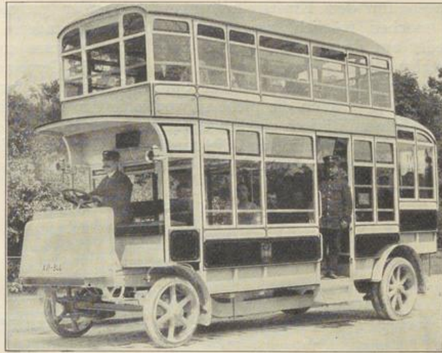
Fig. 6. Wiener elektrischer Akkumulatoren-Omnibus, Patent Spängler. Chassis der Österr. Daimlerwerke.
