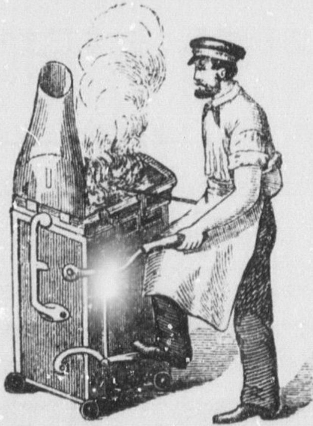
K. k. leichttransportable doppelwirkende Cylinder-Feldschmiede.
