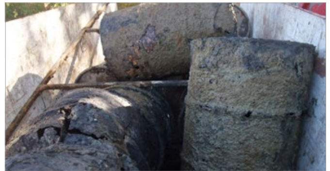
Geborgene Auftriebskörper von Schwimmstegen an der Alten Donau.
