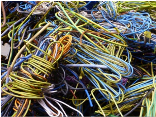
Getrennte Sammlung von unterschiedlichen Materialfraktionen bei Abbrucharbeiten.
