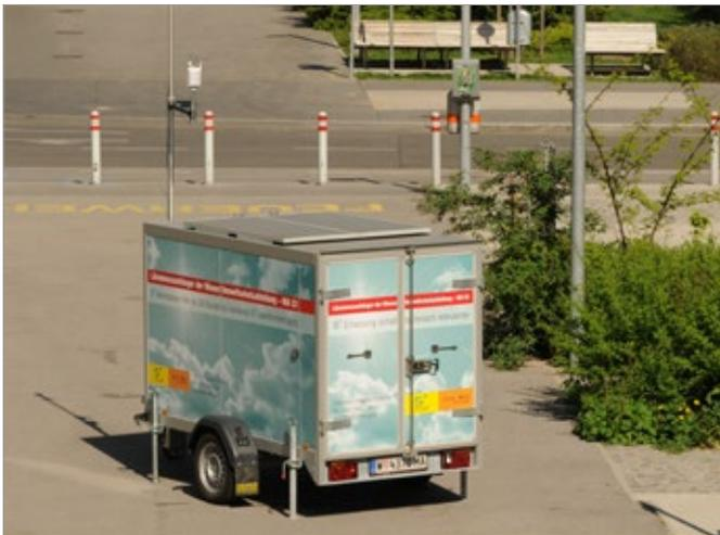
Solarbetriebener Lärmessanhänger der MA 22.
