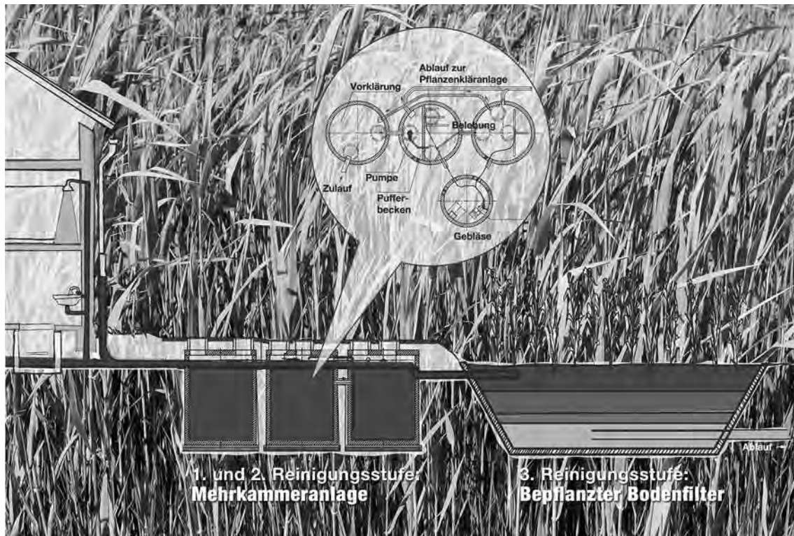
Pflanzenkläranlage Bisamberg © Wien Kanal
