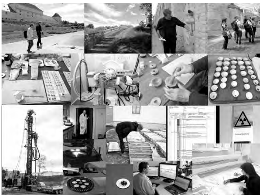
Abb. 5: Fotos von Arbeitsschritten: Gebietsbegehung; Abteufen der Forschungsbohrung P573, Probenaufbereitung für die sedimentpetrographische Untersuchung des Bohrguts und für die Altersbestimmung, Erstellung des hydrogeologischen Modells aufgrund von Bohrprofilen. © WGM
