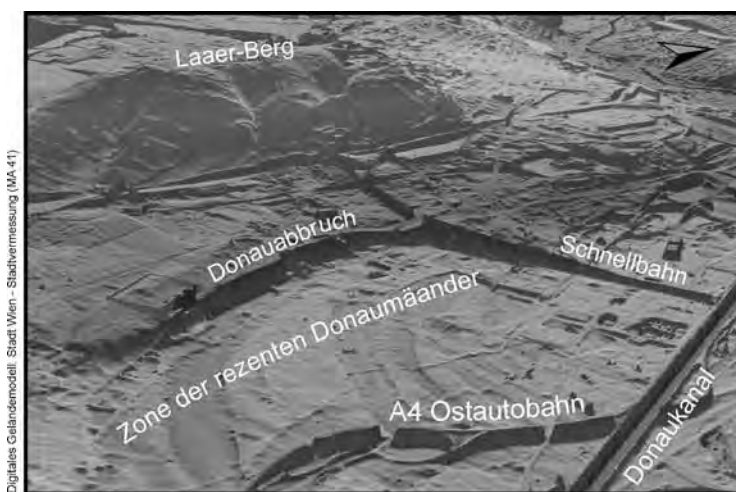
Abb. 2: Digitales Geländemodell von Simmering, 10fach überhöht; Blick nach Nordwesten vom Donaukanal in Richtung Laaer-Berg. Der Donauabbruch in Simmering ist ca. 15 m hoch. Auf der eiszeitlichen Donauschotterterrassenkante befinden sich Schloss Neugebäude und die Umfassungsmauer einer großen Gartenanlage. In der Zone der rezenten Donaumäander sind besonders deutlich die Altarmschlingen von Seeschluchtgraben und Gröhretgraben erkennbar. © WGM
