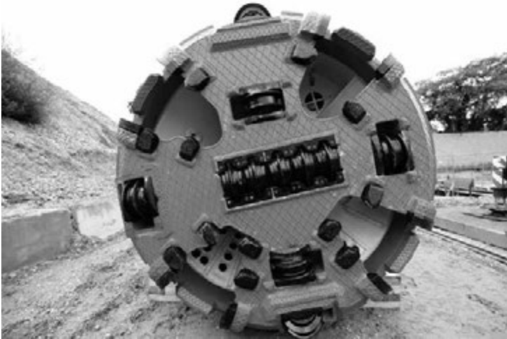
Der kolossale Bohrkopf der Hydroschildmaschine. © Hinterramskogler
