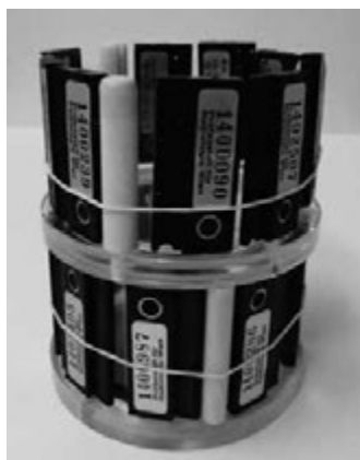
Aufbau der Bestrahlungsvorrichtung mit einer CS-137 Quelle © MA 39
