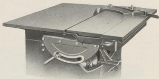
Universal-Kreissäge eingestellt zum Schneiden der Gehrungen an Segmenten
