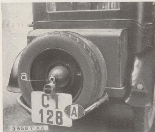
Abb. 32. Befestigung der Reserveräder
