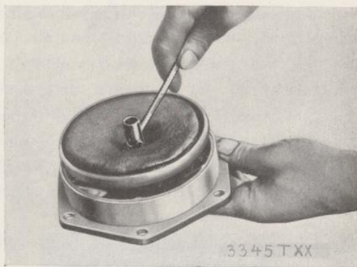
Abb. 8. Zerlegen des Ölsiebes
