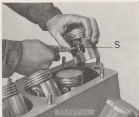
Abb. 19. Sicherung der Kolbenbolzen
