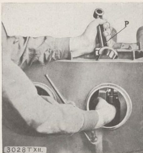
Abb. 21. Ausbau der Pleuelstange
