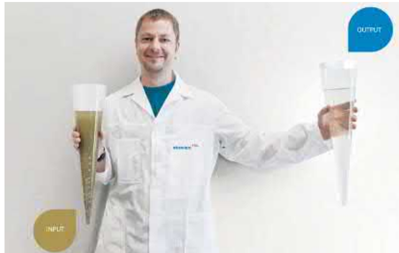
Wiener Abwasser vor und nach der Reinigung
