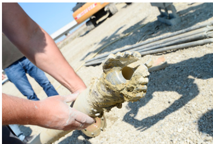
So sieht der Bohrkopf im Detail aus. Fotos: © MA20/A.Kromus
