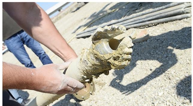
So sieht der Bohrkopf im Detail aus.
