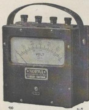
NORMA Drehspulbetriebsspannungsmesser Mod. 17 V, mit 3 Meßbereichen.
