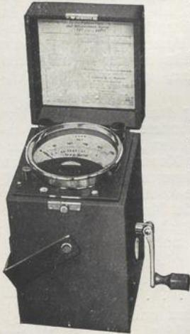
Dies ergibt, daß zunächst das notwendigste Rüstzeug für jeden Elektriker ein einfacher, handlicher Isolationsprüfer ist, welcher bei Induktorspannung 220 Volt mit eingebautem Drehspulinstrument Werte bis 10 Megohm sicher und bis 20 Megohm schätzungsweise abzulesen gestattet. Die Kontrolle der Induktorspannung kann dabei mittels Druckknopf erfolgen. Siehe nebenstehende Abbildung und Beschreibung Listen-Nr. 79.309.
