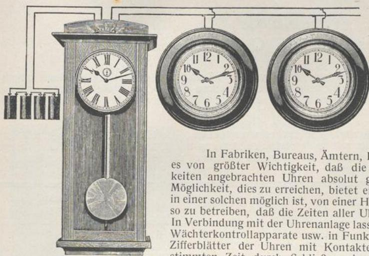
Schema einer elektr. Uhrenanlage, bestehend aus einer Hauptuhr u. 2 Nebenuhren mit Leitungen und Batterie.
