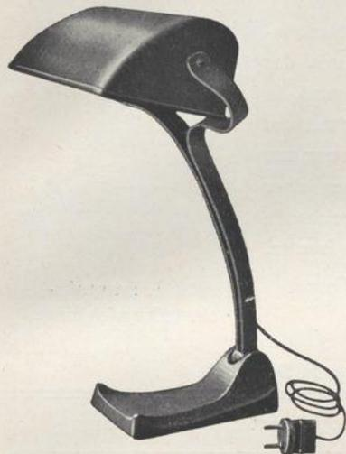
Charakteristisch für die Nike-Lampe ist der muldenförmige, um eine horizontale Achse drehbare Reflektor. Dieser läßt sich immer so einstellen, daß die Glühlampe dem Auge entzogen ist und ermöglicht eine intensive Platzbeleuchtung mit schwacher Lichtquelle; eine Glühlampe von 25 Watt genügt in den meisten Fällen. Die Beleuchtung mit der Nike-Lampe zeichnet sich daher durch hohe Beleuchtungsausbeute und geringen Stromverbrauch aus.
