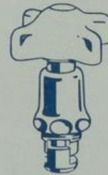
Ausführung „VII“ Nichtsteigende Spindel mit Porzellangriff
