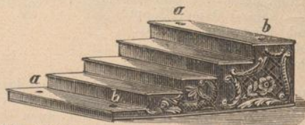
Fig. 1394 1/2 b. Das Geländer kann bei a a oder b b eingesetzt werden.
