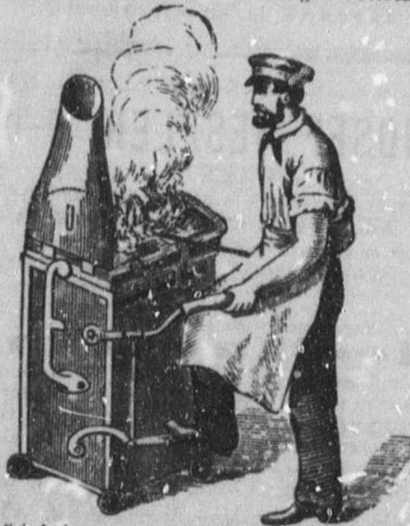
K. k. leicht transportable doppelwirkende Cylinder-Feldschmiede.
