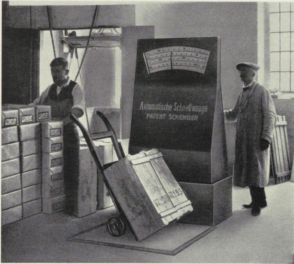
*Vierzeigerwaage — erste, eichfähige Neigungswaage*
