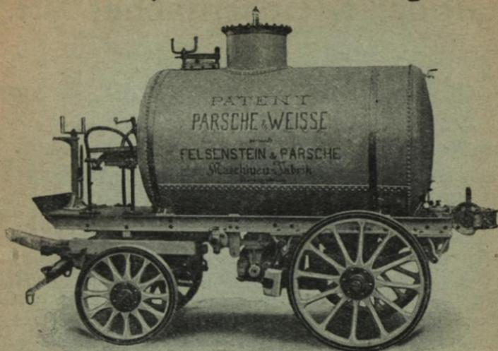
Patent. automatische Aufspritzwagen mit Luftdruck,
